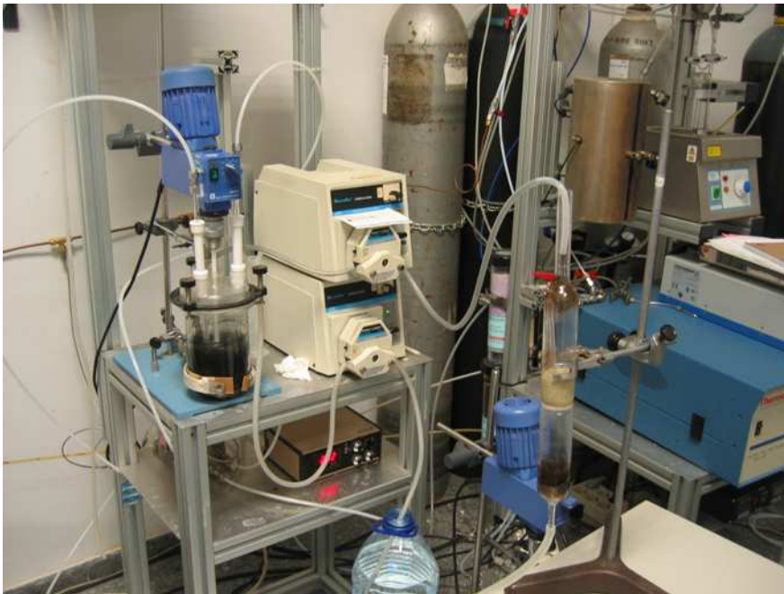
Investigación en continuo del Sistema de eliminación de nitratos en los laboratorios del ITQ.
